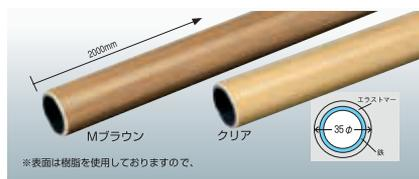
●サイズ：35φ×2000mm ●材質：鉄+エラストマー樹脂 ●重量：3.6kg
